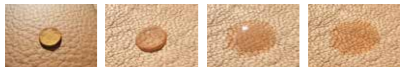
Figuur 1 toont een druppel water op gepigmenteerde koeienhuid. Het water dringt het leer niet binnen. Figuren 2-4 tonen hetzelfde experiment met een leder met open-poriën (semi of vol aniline leder).
